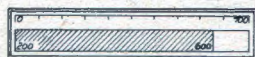
Abb. 1a. Der Wellenbereich ist etwas nach links verschoben, d. h. die Endkapazität ist zu groß.
